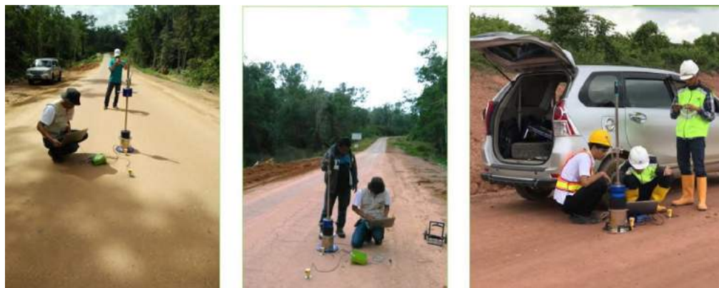
Gambar 4. Contoh Pengujian dengan LWD
